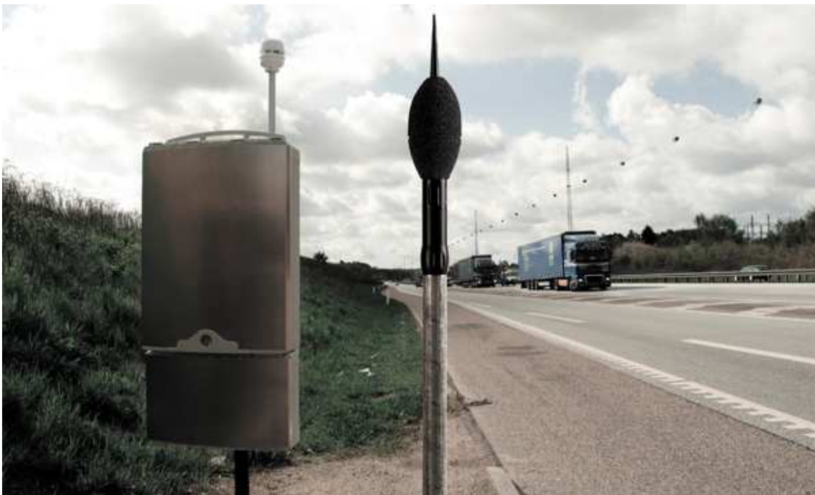
Figura 4: Equipo de medición de niveles acústicos ambientales para una red de monitorización en tiempo real
